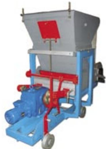
РИС. 2. Общий вид лоткового загрузчика шихты
