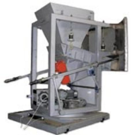
РИС. 4. Общий вид вибрационного загрузчика шихты
