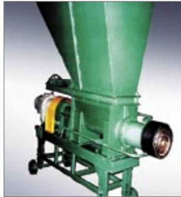
РИС. 6. Общий вид шнекового загрузчика шихты
